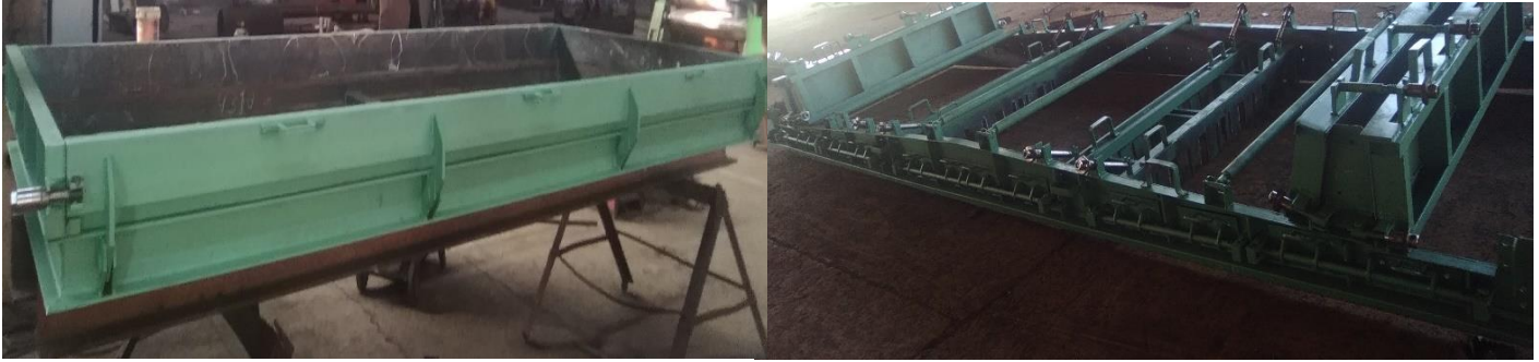
Moldes de losa tablero de hormigón
