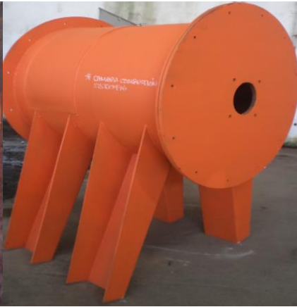
Cámara de combustión
