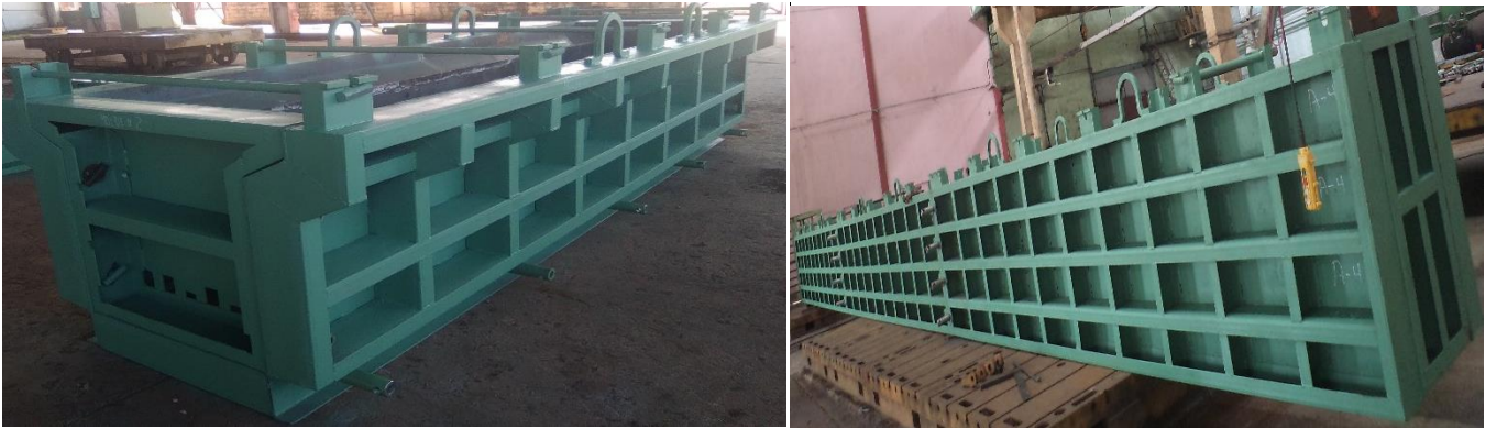
Moldes de viga de hormigón
