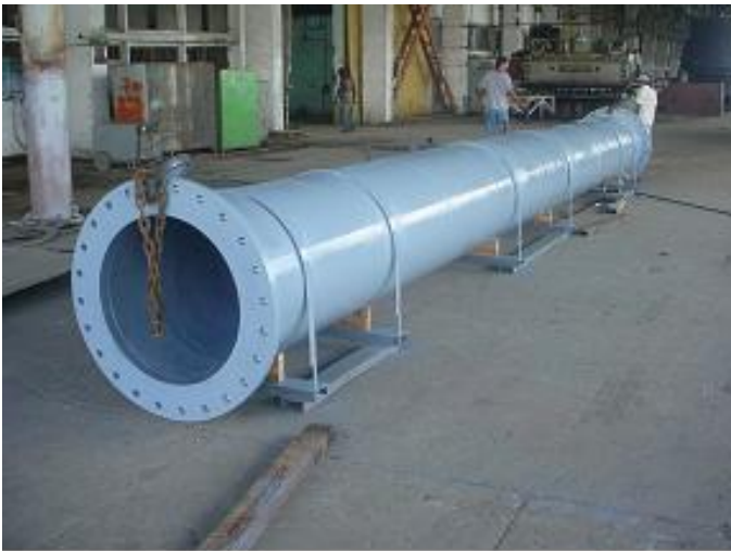
Tubería de descarga para Draga
