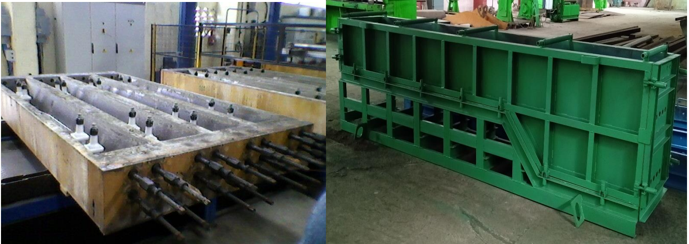
Molde para traviesas de hormigón
