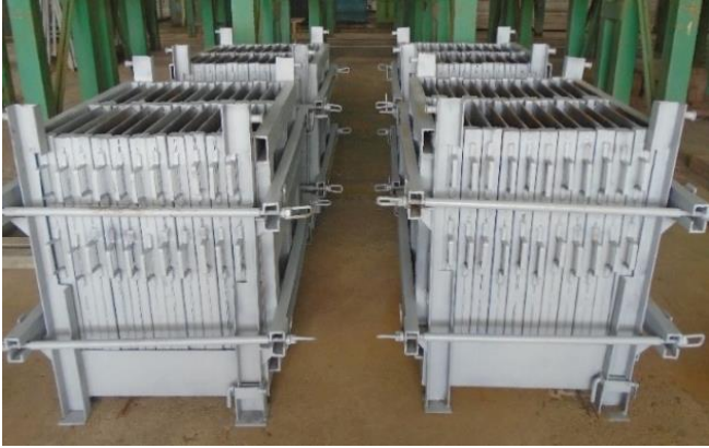
Moldes para columnas
